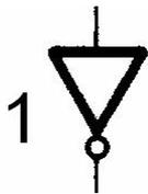
Puerta lógica inversora. Cuando a la entrada le llega un nivel bajo (0), a la salida se tiene un nivel alto (1) y viceversa, cuando en la entrada existe un nivel alto (1), a la salida hay un nivel bajo (0).
